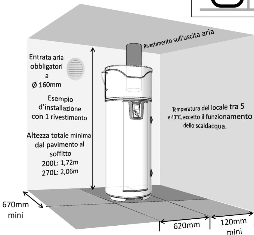
Temperatura del locale tra 5 e 43°C, eccetto il funzionamento dello scaldacqua.
