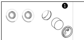
Togliere il tappo e la schiuma dall'alloggiamento a fianco delle derivazioni dello scambiatore interno.
