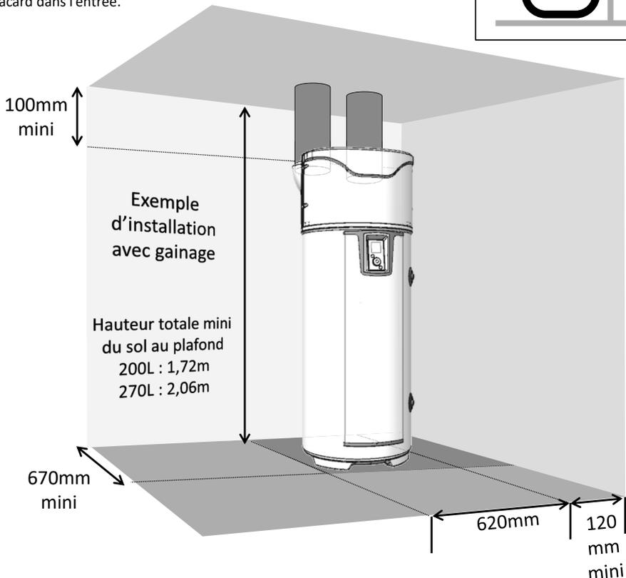
⚠ Respecter les longueurs maximales de gaines. Utiliser des gaines rigides ou semi-rigides calorifugées. Prévoir des grilles à l'entrée et à la sortie d'air pour éviter l'intrusion de corps étrangers. Attention, les grilles entrée et sortie d'air à obstruction manuelle sont interdites
