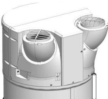
Odvisno od vlage v zraku se lahko nabere **do 0,5l/h kondenzata**. Kondenzati ne smejo odtekati neposredno v kanalizacijo, saj bi lahko amonijevi hlapi, ki se dvigajo iz kanalizacije, poškodovali lamele v izmenjevalniku toplote in sestavne dele toplotne črpalke.
