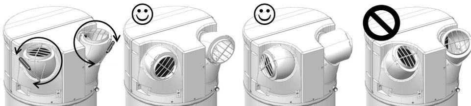
❶ Otpustite vijke otvorâ, a potom otvore okrenite u odabranom smjeru zakrećući ih.
