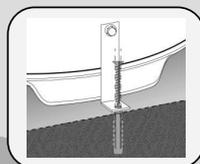
Fissare lo scaldacqua con la flangia di fissaggio in dotazione.
