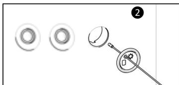
Provucite sondu za temperaturu kroz čep (čep je probušen u tu svrhu).
