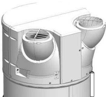
W zależności od wilgotności powietrza tempo skraplania może wynosić **do 0,5 l/h**. Przepływ skroplin nie powinien być odprowadzany bezpośrednio do kanalizacji, ponieważ wydostające się z kanalizacji opary amoniaku mogą uszkodzić żeberka wymiennika i części pompy ciepła.
