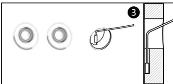
Insérer la sonde dans la goulotte en veillant à ce qu'elle soit bien positionnée au fond du logement.
