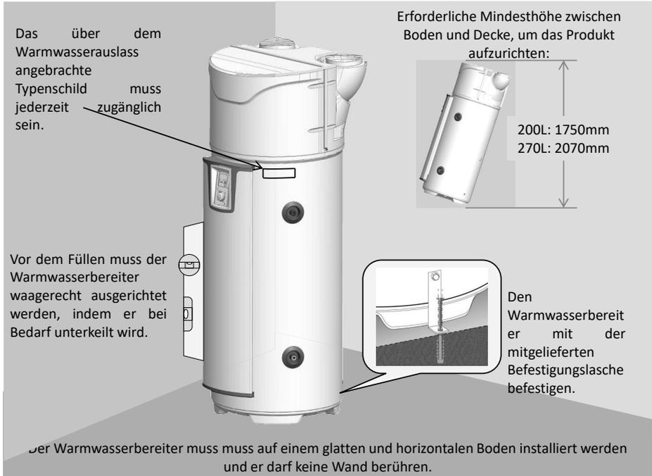
**Der Warmwasserbereiter muss unbedingt (gemäß Artikel 20 der Norm EN 60335-1) mit Hilfe der dafür vorgesehenen Befestigungslasche am Boden befestigt werden.**
