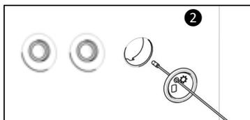
Passare la sonda di temperatura attraverso il tappo (il tappo è stato forato).
