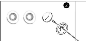
Passer la sonde de température à travers le bouchon (le bouchon a été percé à cet effet).
