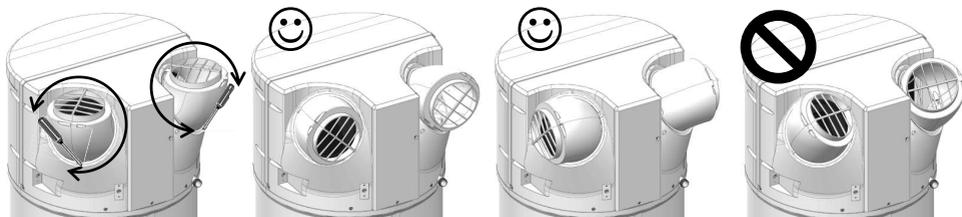
❶ Odkręcić wkręty blokujące wlot/wylot powietrza, a następnie, obracając wlot/wylot ustawić go w wybranym kierunku.
