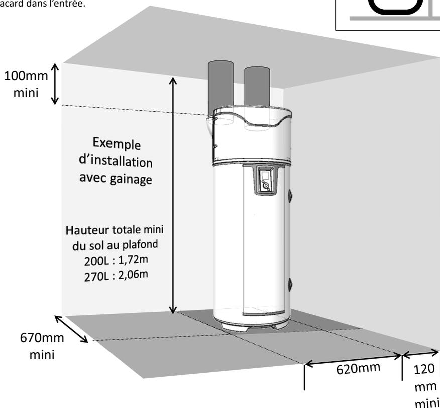
⚠ Respecter les longueurs maximales de gaines. Utiliser des gaines rigides ou semi-rigides calorifugées. Prévoir des grilles à l'entrée et à la sortie d'air pour éviter l'intrusion de corps étrangers. Attention, les grilles entrée et sortie d'air à obstruction manuelle sont interdites
