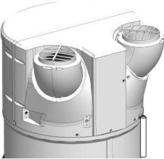
Afhankelijk van de vochtigheid kan er **tot 0,5l condens per uur gevormd worden**. Deze condens mag niet rechtstreeks wegstromen naar de riolering, want ammoniakdampen die uit de riolering gestuwd worden, zouden de lamellen van de warmtewisselaar en de onderdelen van de warmtepomp kunnen beschadigen.
