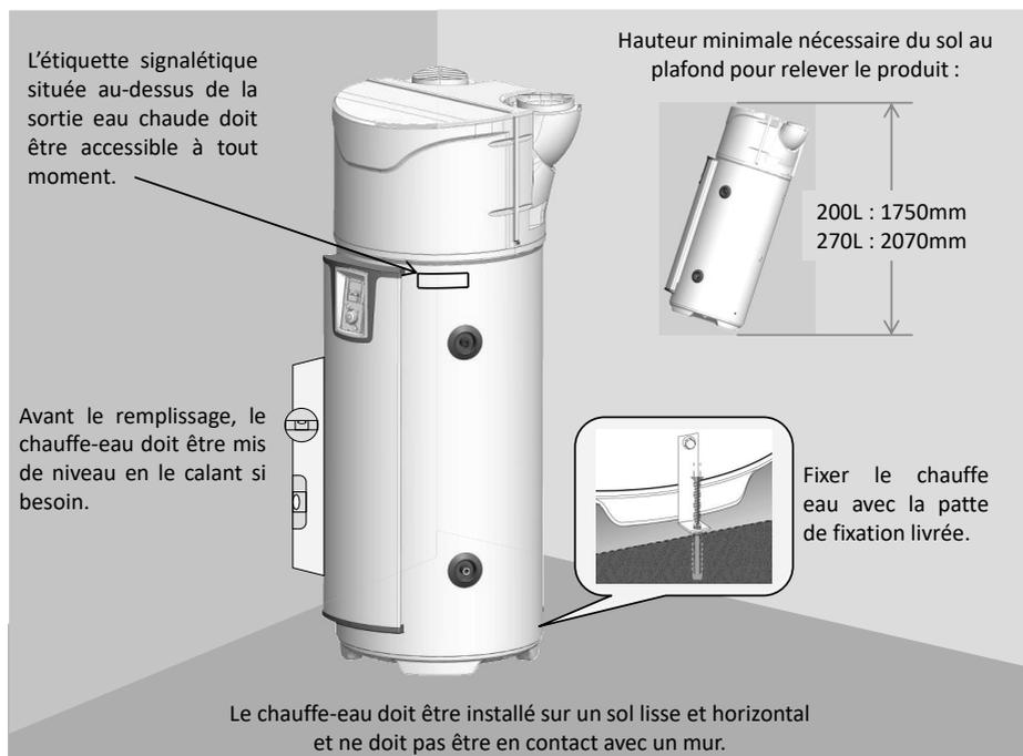
**Le chauffe-eau doit obligatoirement (conformément à l'article 20 de la norme EN 60335-1) être fixé au sol à l'aide de la patte de fixation prévue pour cet usage.**
