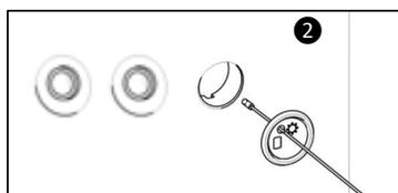
Passare la sonda di temperatura attraverso il tappo (il tappo è stato forato).
