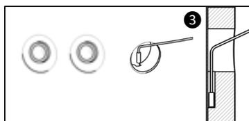
Inserire la sonda nella canalina facendo attenzione che sia correttamente posizionata sul fondo dell'alloggiamento.
