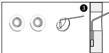
Włożyć czujnik w ryneczkę, dbając o to, by był on prawidłowo umieszczony w głębi gniazda.
