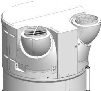
Je nach Feuchtigkeit der Luft können sich **bis zu 0,5l/h an Kondensaten** bilden. Der Abfluss dieser Kondensate darf nicht direkt in den Abwasserkanal durchgeführt werden, denn die Ammoniakdämpfe, die aus dem Abwasserkanal zurückgedrückt werden, könnten die Lamellen des Wärmetauschers und die Teile der Wärmepumpe beschädigen.
