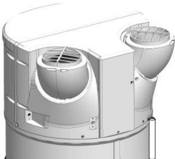
Ovisno o vlažnosti zraka, može se stvoriti **do 0,5l/h kondenzata**. Otjecanje tih kondenzata ne bi trebalo biti usmjereno izravno u kanalizaciju jer pare amonijaka iz kanalizacije mogu oštetiti lamele topline i dijelove toplinske pumpe.
